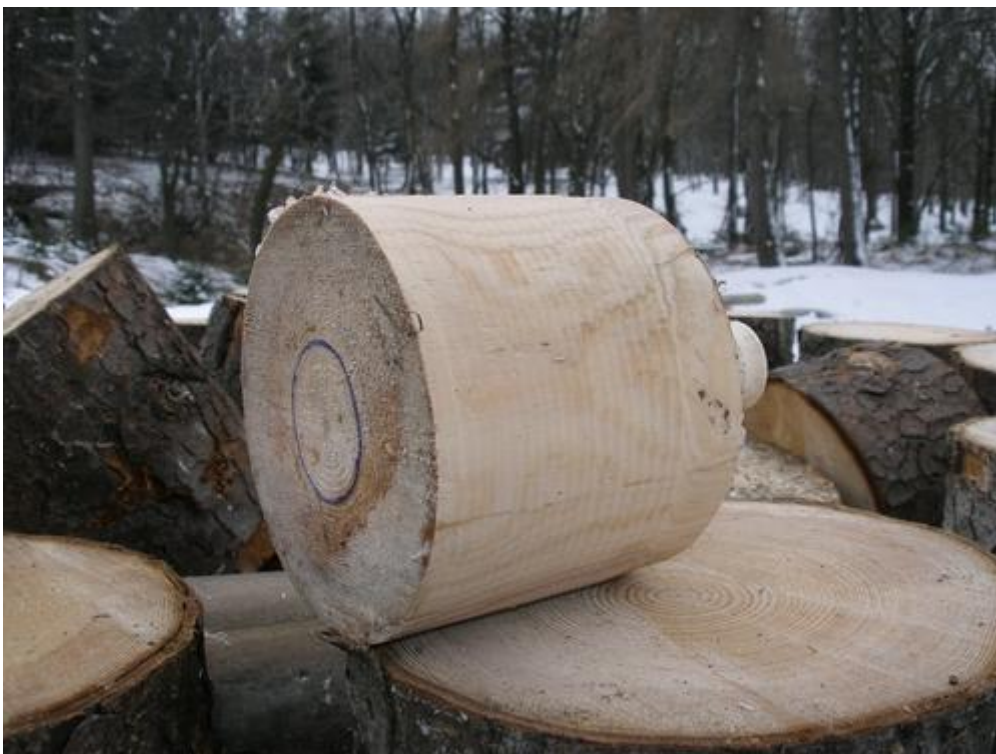
Der Durchmesser richtet sich nach dem zu drehelnden Tier. Mit Schablonne ist der Ansatzpunkt fürs Anschlagfutter vorgezeichnet.
