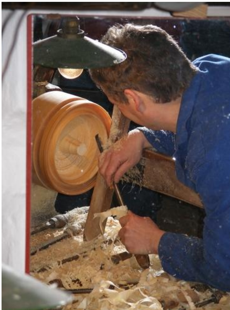
Über einen Spiegel kann man beim Drechseln direkt die Werkzeugführung beobachten. (Der Drechsler war kein Linkshänder).
