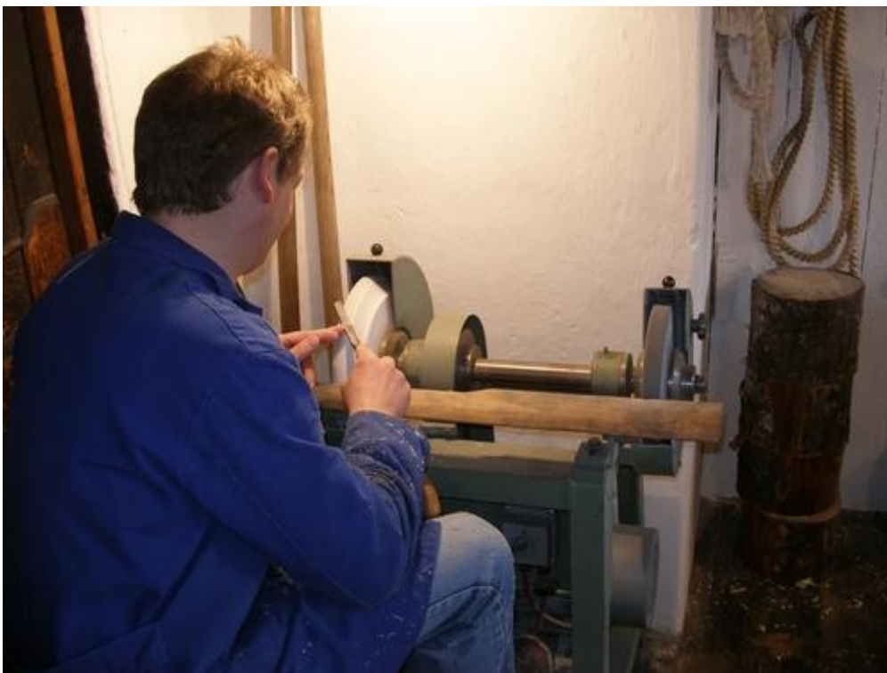
Erst einmal das Werkzeug nachschleifen. Das Werkzeug ist komplett aus deutschen Schmieden (z. B. Gläser)
