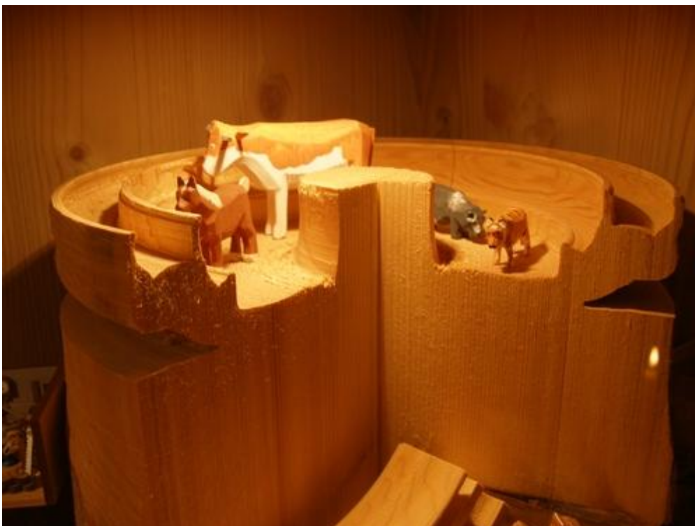
So sieht der Holzquerschnitt beim Drechseln aus.
